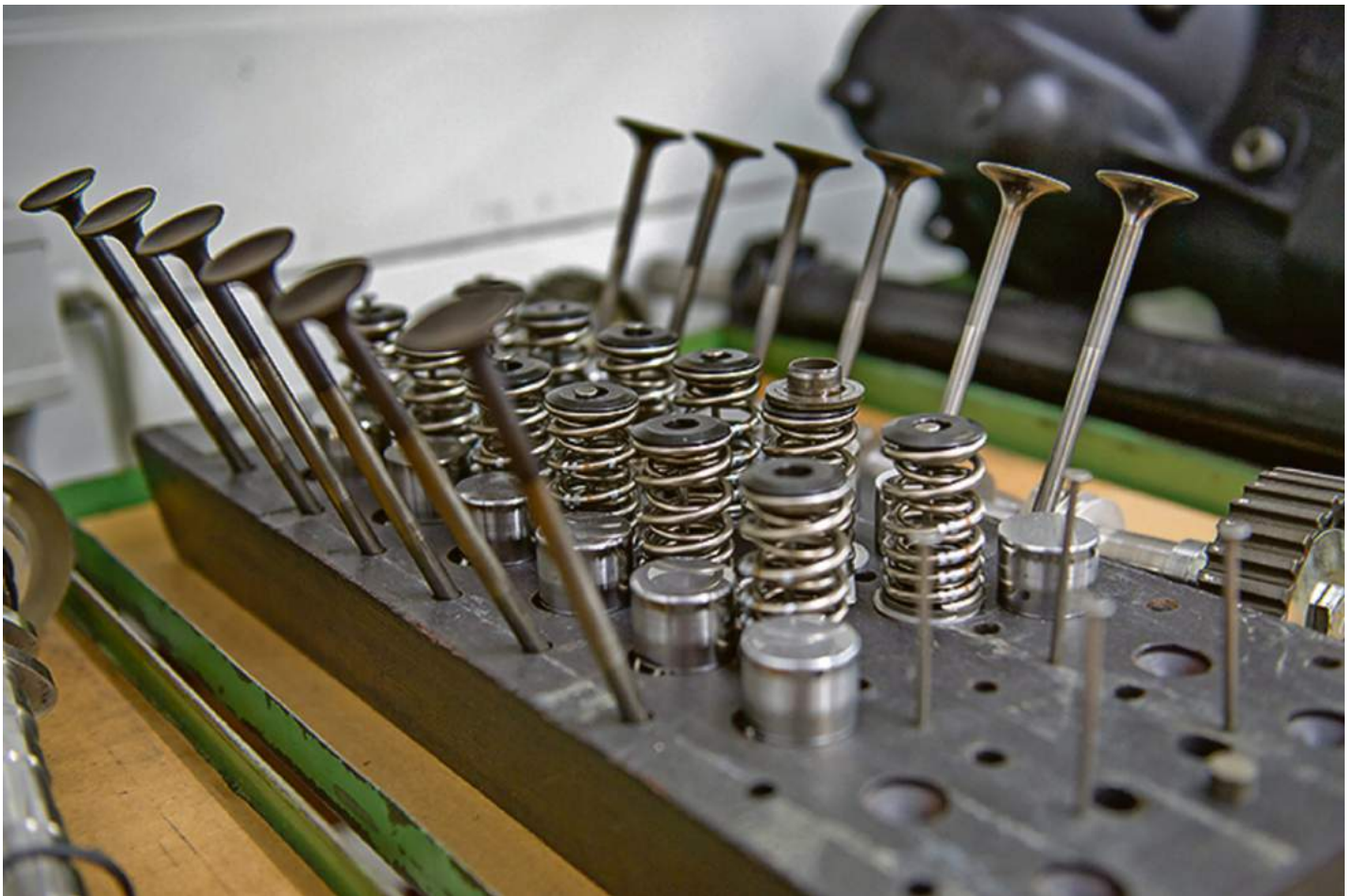
Ventilsatz eines Formel-1-Motors. An Kumschick war während Jahren in der Historischen Formel 2 wie in der TGP, heute der Historischen Formel 1, kein Vorbeikommen.
